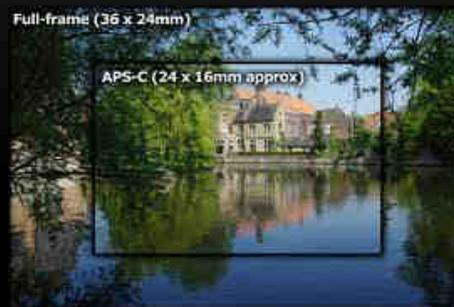
Ces deux images mettent en évidence que pour une même Focale l'image formée sur le capteur n'est pas la même en raison de la différence de taille de ces derniers
