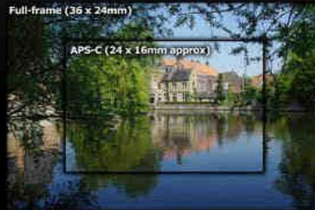
**Ces deux images mettent en evidence que pour une même Focale l'image formée sur le capteur n'est pas la même en raison de la différence de taille de ces derniers**
